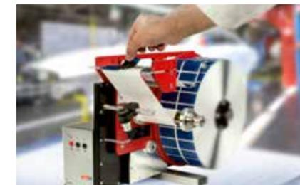
Stationäre Abroller für Stanzteile und Rollenmaterial mit einfach wechselbaren Magazinen
